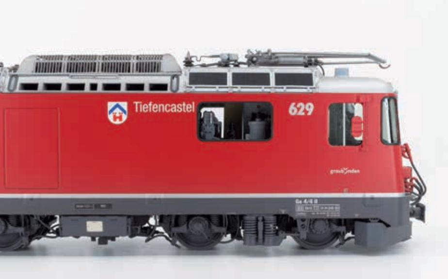
Ge 4/4 II von Model Rail mit neuen Federn und der Tafel am Batteriekasten.
